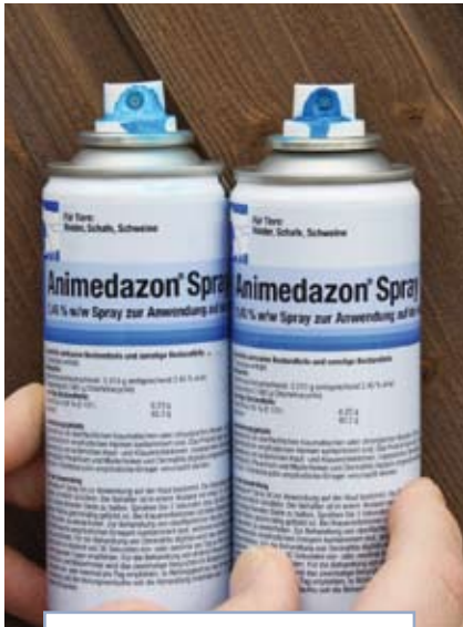
Deutlicher Unterschied an den Düsen: Die linke Dose war kalt und die rechte vorgewärmt.
